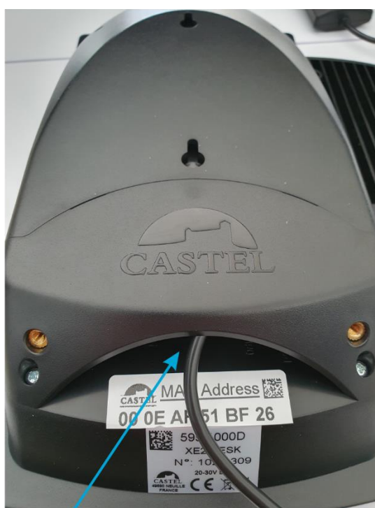
Entrée du cordon dans le poste
